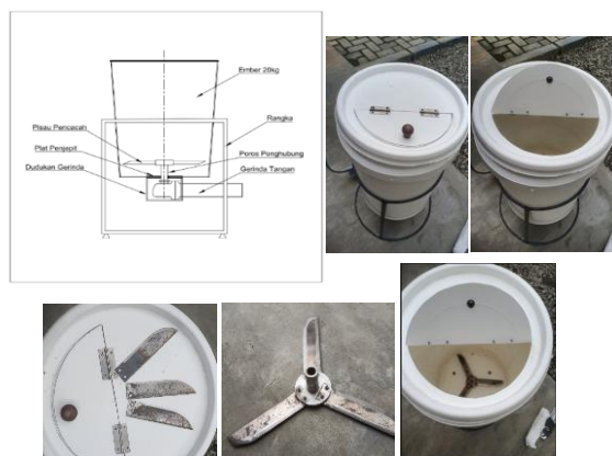
Gambar 2. Sketsa dan Hasil Pembuatan Mesin Pencacah Sampah
