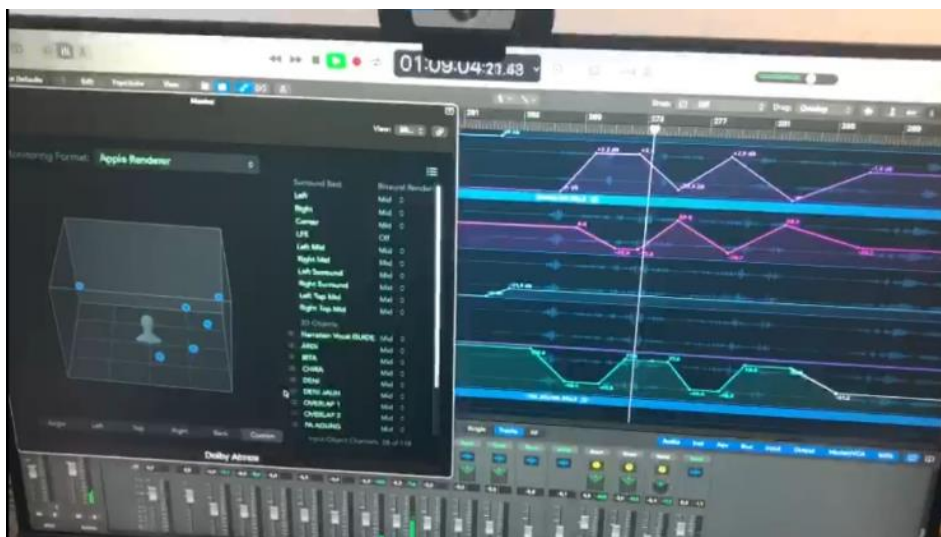
Gambar 3. Proses Audio Mixing - Ekstraksi 2 Kanal Menjadi 5.1 Kanal dengan Fitur Automation
